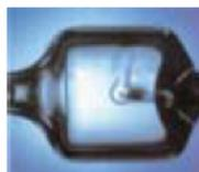
*All'interno di una lampada ad alogeni ad alta pressione si verificano forti turbolenze causate dal processo di convenzione*
