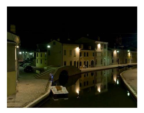
La sorgente luminosa scelta è una recente tecnologia, Cosmopolis Cosmowhite, lampada a scarica di basse potenze ed alta efficienza luminosa a luce bianco calda; la potenza prescelta è la più bassa, 45W con un flusso luminoso di 4300 lumen, con temperatura colore 2720°K.
