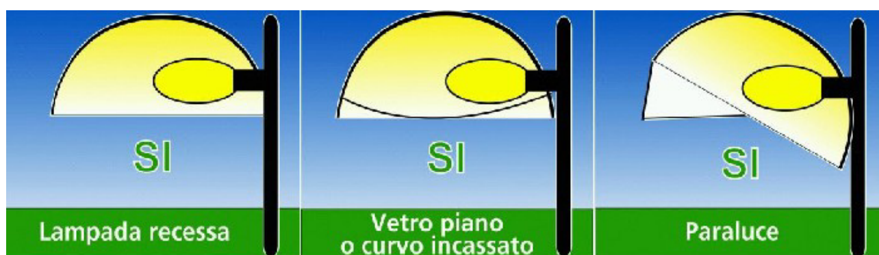
Fig. 2 - Tipologie di apparecchi conformi alla L.R. 19/2003
