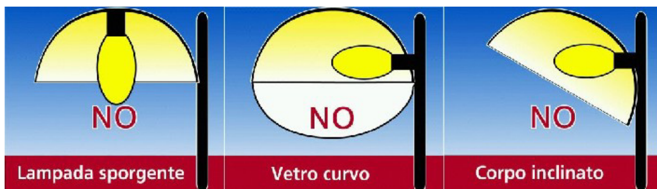
Fig. 1 - Tipologie di apparecchi non ammessi dalla L.R.19/2003
