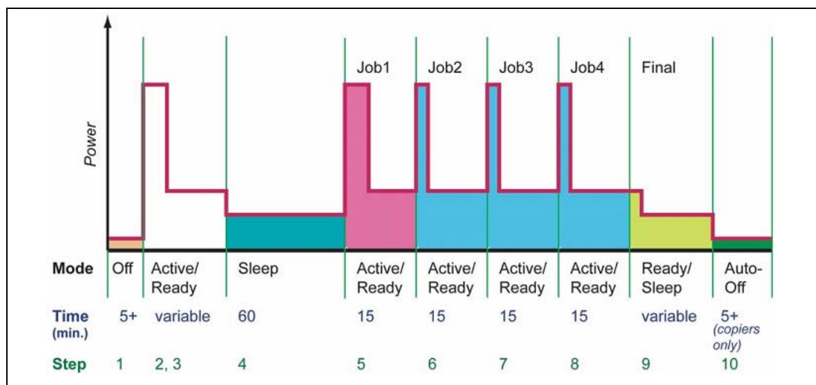
Figura II.1 – Schema esemplificativo di una procedura di test in 10 step adottata dal programma Energy Star per la valutazione del consumo energetico tipico TEC (Wh/settimana) d una certa tipologia di apparecchi [9]
