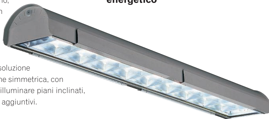
Figura 1 - L'apparecchio qui proposto, con corpo in acciaio zincato e riflettore in alluminio ad altissimo grado di riflessione, si installa a soffitto, su tige o catenaria. Le staffe di montaggio consentono un'inclinazione fino a 50°. Può utilizzare 3 tipi di ottiche, monta 2, o 3 o 4 fluorescenti T5 da 49 o 54 W (apparecchio Titus Industry di Thorn)
